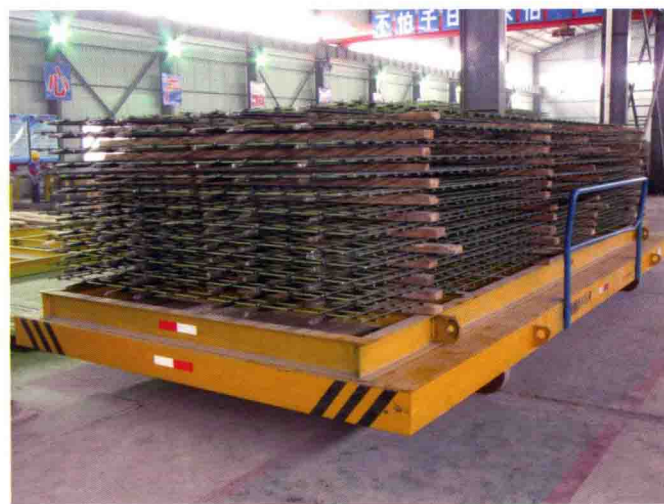
钢筋网片运输
