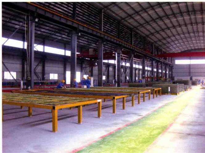
钢筋网片绑扎胎具
