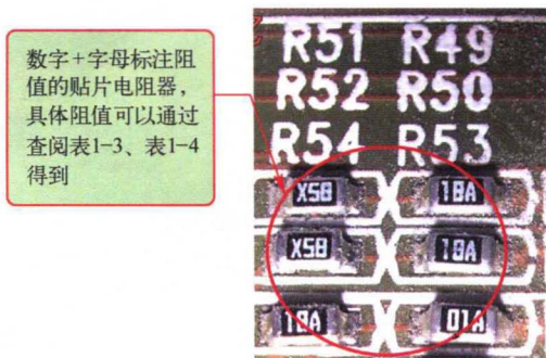
图 1-13 数字 + 字母标注阻值的贴片电阻器
