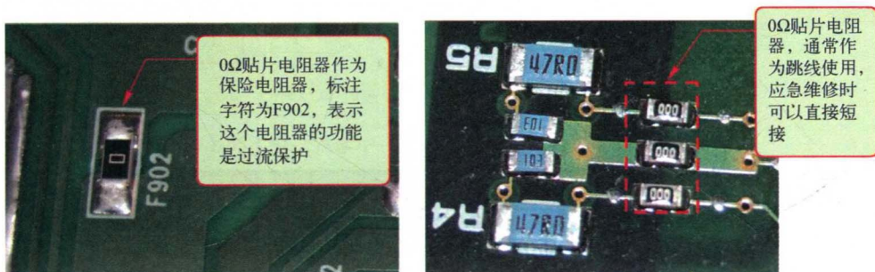
图1-14 阻值为 0\Omega 的贴片电阻器
