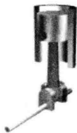
图 2-1 内燃机的主运动机构
