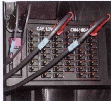
图 3-53 总线系统检测箱就车连接 CAN 连接插座
