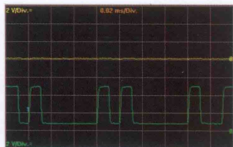
图 8-26 CAN-High 对地短路
