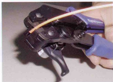
图 4-44 将光缆粗略地剪开
