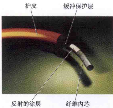
图 4-2 光缆结构
