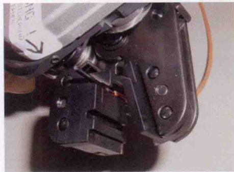
图 4-46 将光缆放到钳子中并将钳口闭合
