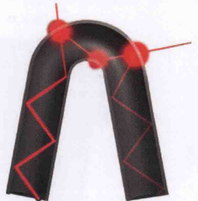
图 4-7 弯曲半径不能小于 50mm
