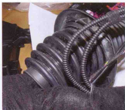
图 4-10 光缆摩擦部位会造成光损失
