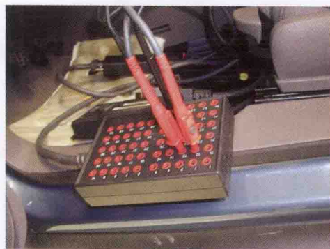
图 3-38 双通道模式下检测 CAN
