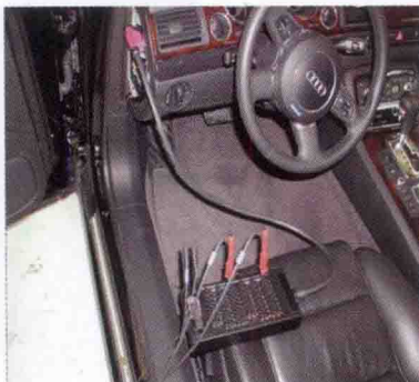
图 3-53 总线系统检测箱就车连接 CAN 连接插座
