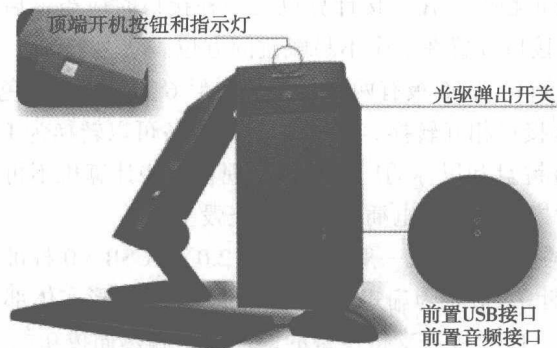
图 1-1 主机前面板接口示意图
