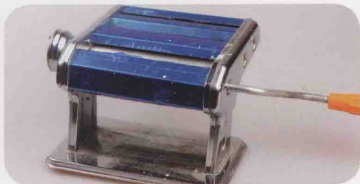
10 压面机：用于压薄片，也可以用另一端压人物的头发丝。
