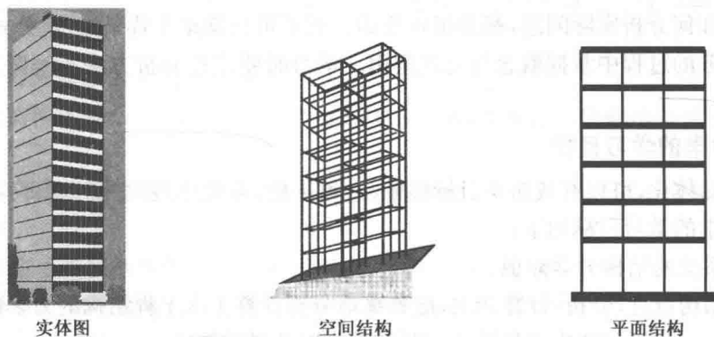
图 0-5 结构体系的简化过程
