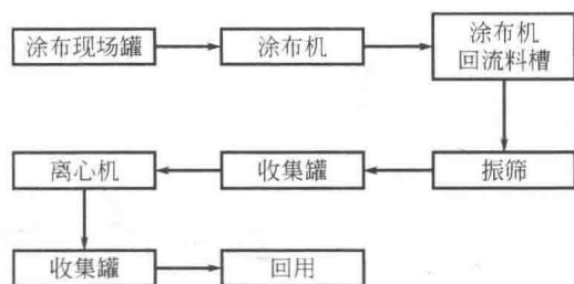
图 1-1 涂布液净化流程示意图
