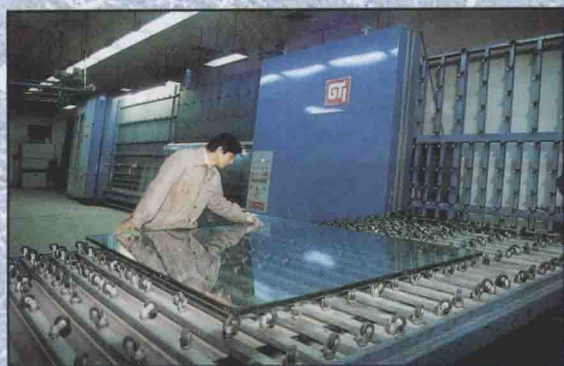
1983年上海耀华玻璃厂从奥地利引进的双层中空玻璃生产线
