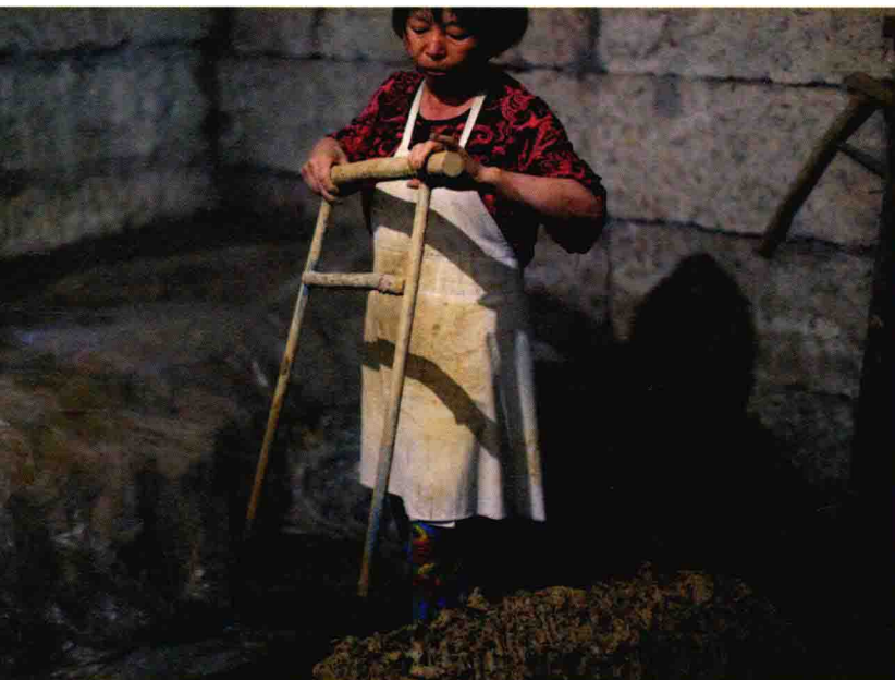
左：朱章火妻子在切泥（这是半成品泥，缙云话管它叫黄金泥，从田里挖出后，晒干，脚踏，剔除粗的颗粒物，再弄湿，存放在阴凉处）。切过的泥，更细发，更上手。切泥的工具，当然是自家做的啦。 右：揉泥，像极了揉面。
