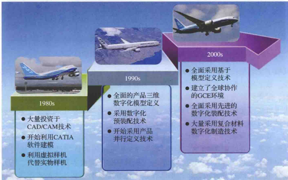
图 1-3 数字化设计制造技术在波音公司的发展和应用
