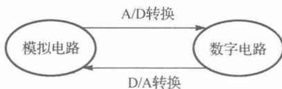
图 1.4 模数转换/数模转换是模拟电路与数字电路的联系纽带
