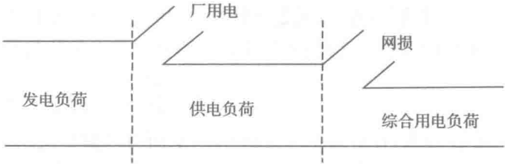
图 1-7 电力系统负荷间的关系
