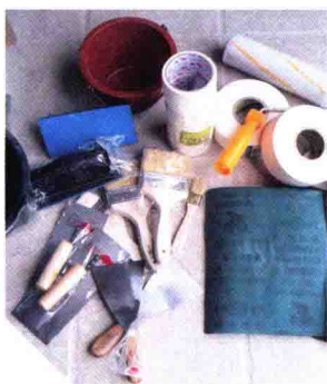
14 油漆、涂饰构造材料 进场，粘贴防裂带
