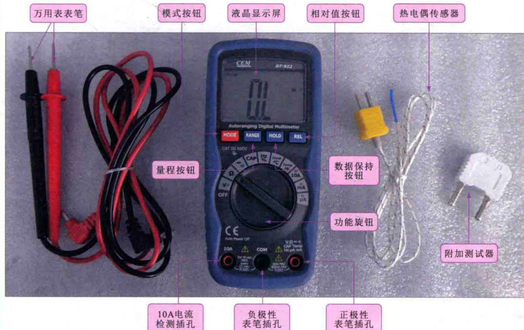
图1-7 数字万用表的结构
