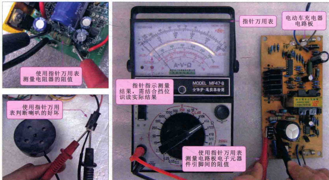
图1-6 指针万用表在电动车维修中的应用
