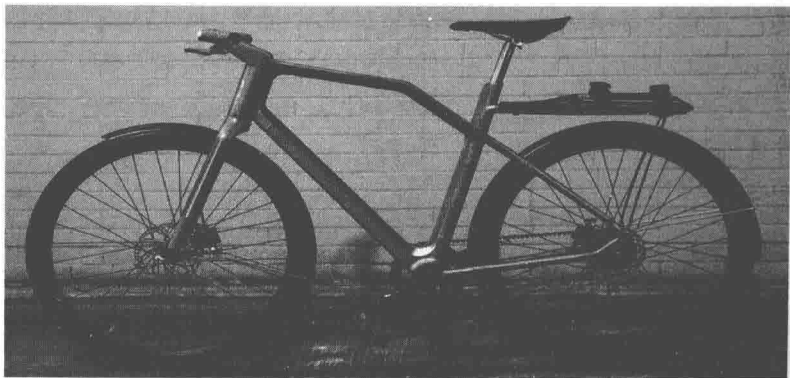
图 1-2 Empire 试制了一辆仅供展示的 3D 打印钛金属自行车车架
