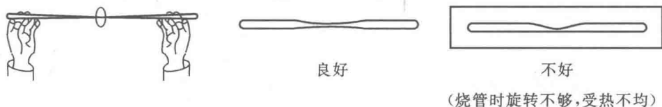
图4-1-6 拉管方法和拉管好坏比较
