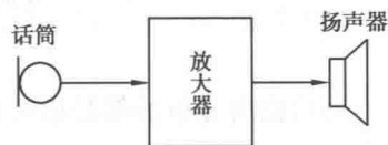
图 1.1.2 扩音器电路示意图
