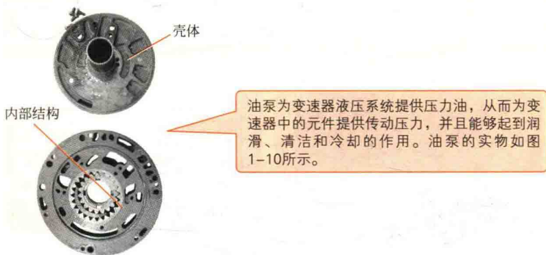
图1-10 自动变速器的油泵实物
