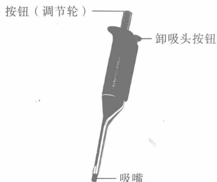
图 1-1-3 可调式移液器的结构
