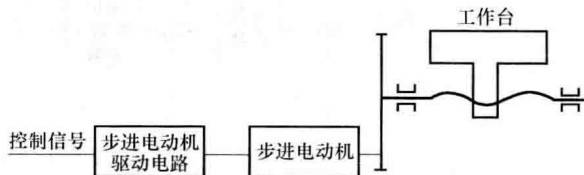
图 0-2 开环数控系统的工作原理图
