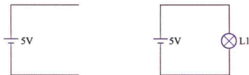
(a) 断路：有电压没有电流 (b) 闭合回路：有电压有电流
