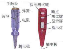
(a) 氖泡改锥式 (b) 电子笔式 常用验电器外形
