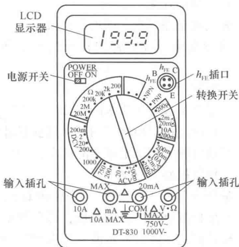
图 1-12 DT-830 型数字式万用表的面板图
