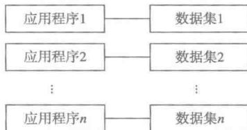
图 1-1 人工管理阶段应用程序和数据之间的关系
