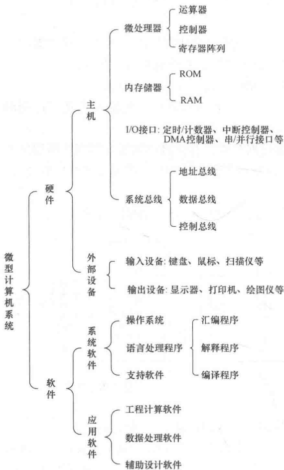
图 1-2 微型计算机系统组成
