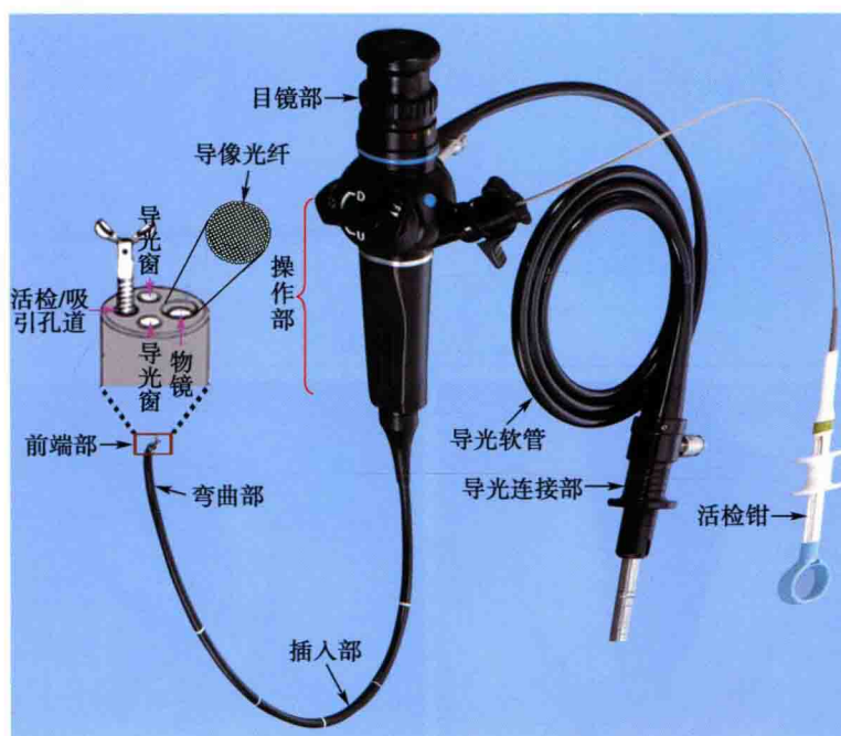
图 1-5 纤维喉镜基本构造示意图 (Olympus ENF-T3)
