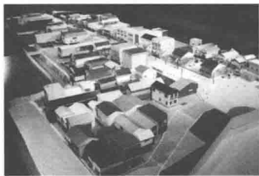
图1-8 立面粘贴实际建筑照片的建筑模型
