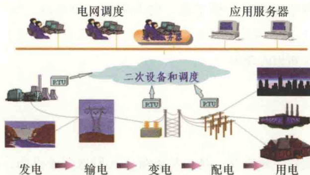
图 1-1 电力系统组成图
