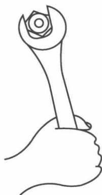
图 1-3 呆扳手操作方法示意
