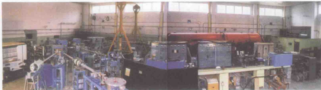
图 1-3 北京大学加速器质谱 ^{14}\text{C} 测年装置
