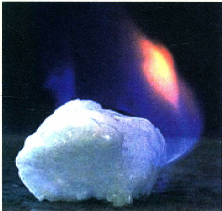
图 1-1 实验室内合成的天然气水合物在燃烧
