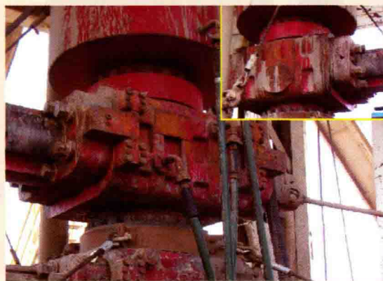
图 1-1-16 无旁侧孔防喷器
