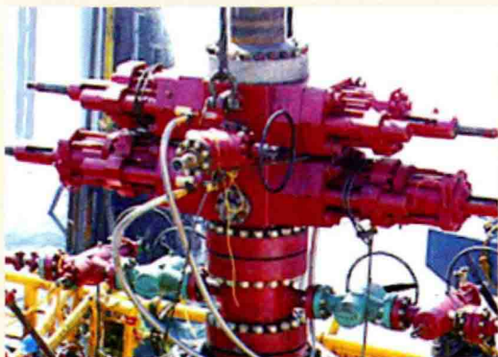
图 1-1-17 旁侧孔接闸门与管线接头
