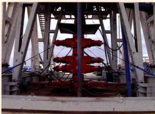
图 1-1-5 空间宽敞的电动钻机底座 (图一)
