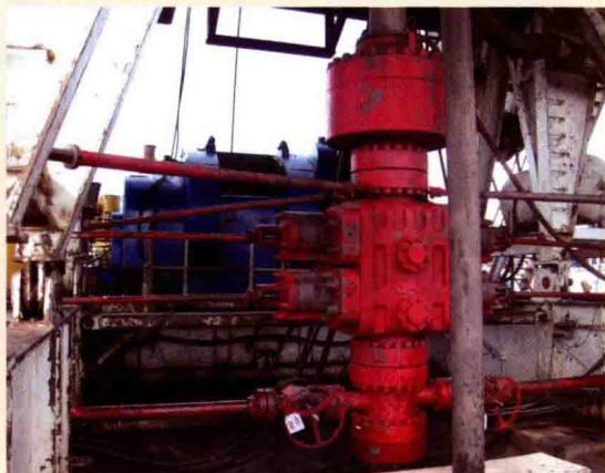
图 1-2-4 装齐手动操作杆(图二)
