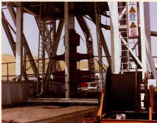
图 1-2-3 装齐手动操作杆(图一)
