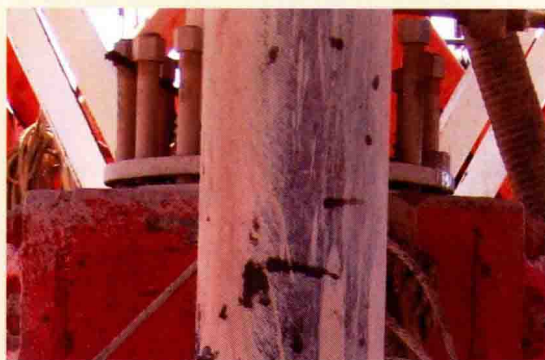
图 1-1-24 不用的螺孔用螺栓封堵
