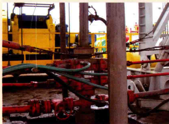
图 1-1-15 小通径无旁侧孔防喷器
