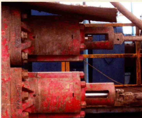
图 1-2-5 关井时手动操作杆脱开锁紧轴
