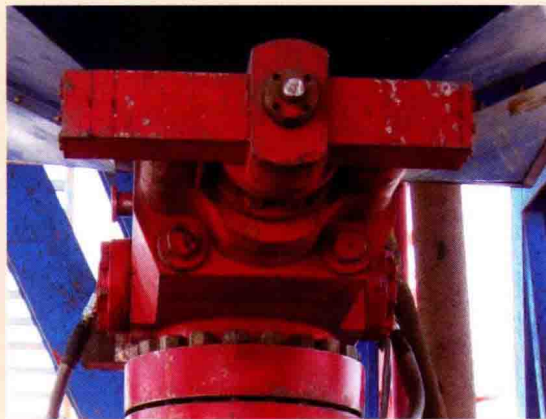
图 1-1-14 防喷器两侧都有旁侧孔和液压管线接口
