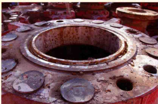
图 1-1-23 不用的螺孔用专用橡胶帽封堵
