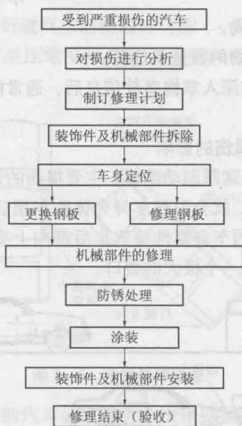
图 1-1 汽车碰撞损伤的主要修复步骤
