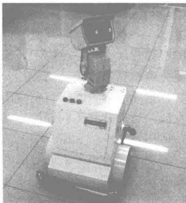
图1-1 变电站巡检机器人
