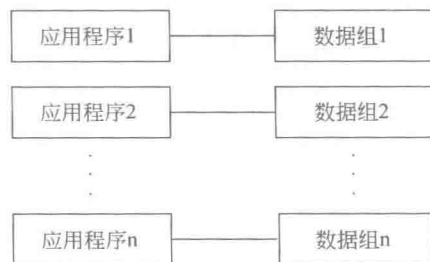
图 1-2 人工管理阶段应用程序与数据的关系
