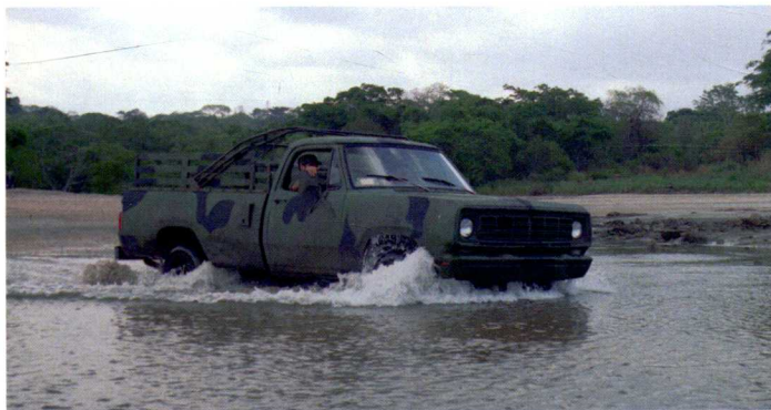
（上图）道奇 M880 1.25 吨 4×4 和 4×2 卡车以克莱斯勒公司的 W200 商用皮卡为基础，于 1973 年开始研发，是“商用多用途货车”（CUCV）家族的组成部分。它设计用于取代 M715 和 M37。（美国国防部）
