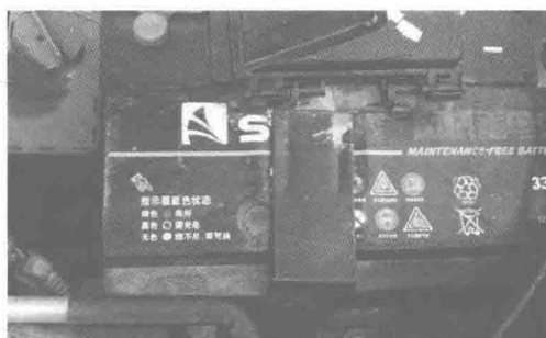
图 1-16 装上蓄电池压板
