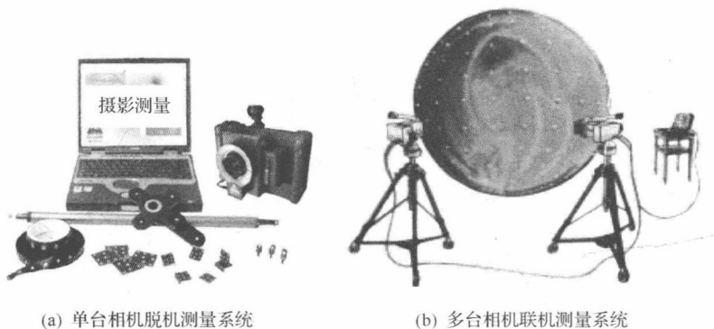
图 1.16 数字近景工业摄影测量系统
