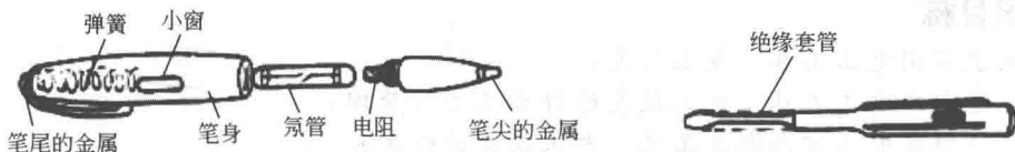
图 1-1 验电笔的结构
