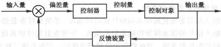
图 1-4 闭环控制系统
