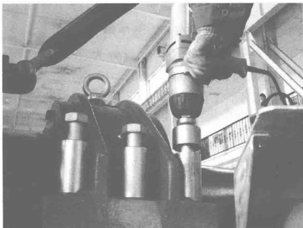
图 1-2-5 电动扳手操作示意图
