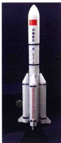
长征五号火箭，外号“冰箭”，采用无毒无污染的液氧液氢推进剂，是绿色环保大型液体运载火箭
