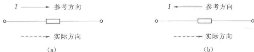
图 1.1.3 电流的参考方向与实际方向
