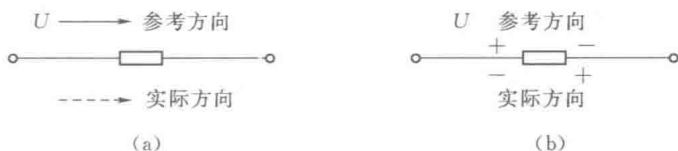
图 1.1.4 电压的参考方向与实际方向
