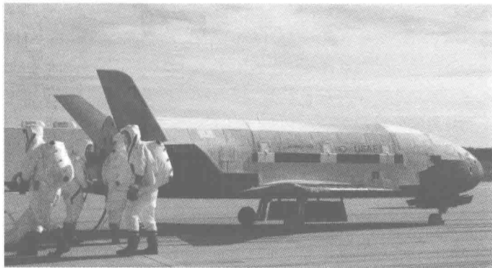
X-37B空天飞机是世界上第一架既能在地球卫星轨道上飞行，又能进入大气层飞行的航空器，其最高速度达到声速的25倍以上
