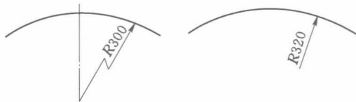
图 1-2-12 大圆弧半径的标注方法
