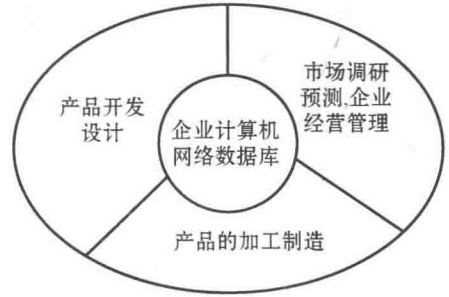
图 1.3 计算机集成制造系统的功能
