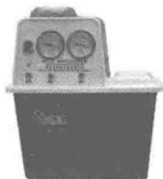
图 1-9 循环水真空泵
