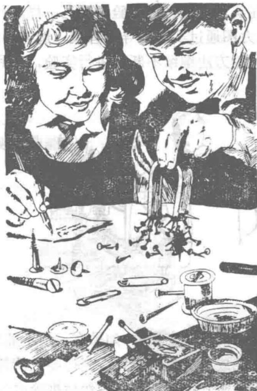
用磁铁轮流地靠近每一样东西，看看哪些东西能被磁铁吸住，哪些东西不能被磁铁吸住；把每样东西都试它几次，从而认识到被磁铁所吸并不是一种偶然的现象。然后，列出一张表，分别记下哪些东西能被磁铁吸住，哪些东西不能被磁铁吸住。那些能被磁铁吸住的物体叫做“磁性物体”，不能被磁铁吸住的物体叫做“非磁性物体”。
