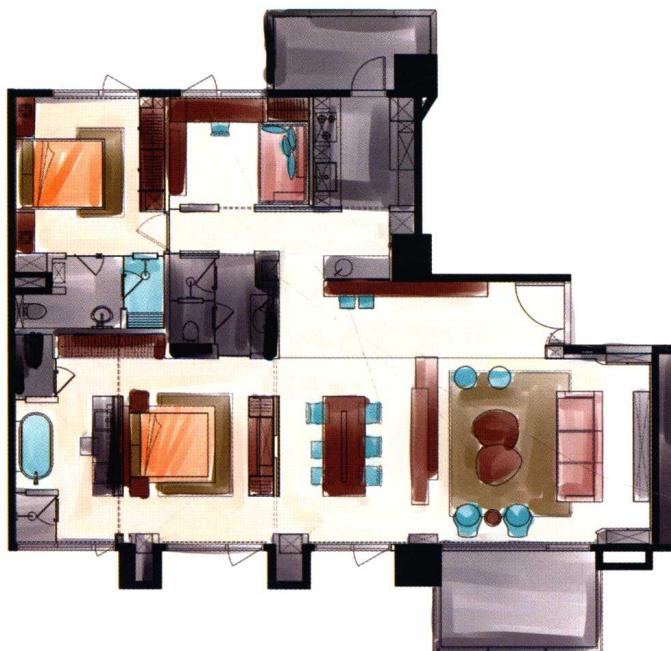
设计师以三道梁体划分四格空间，隐喻空间中轴与回字平面。以光廊动线串联各空间场域，形成自由流动又各自独立的空间。框架式天花板设计与浅色橡木地板，区隔主、次空间层次。深色的石材地板，转折而上的墙屏，展开宽阔的面，强烈形塑玄关空间的开与合。嵌墙的吧台柔化转角墙面，巧妙融合不同空间机能的面向。穿透玻璃引进暖光，解决走道与客卫的采光，走道两侧脱开的墙面，运用拉门开合的变化，呈现光影交错的效果，三个微空间就此延伸。
